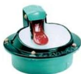
Heizbares Tränkebecken für Offenstallungen (Mod. 41A). Geeignet für Rinder, Pferde und Schweine. Schale aus Gusseisen, innen emailliert und mit robustem Zungenventil. Frostsicher bis ca. -25°C. Anschluss R 1/2 von unten.
