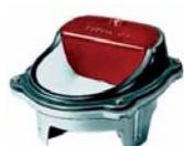
Heizbares Tränkebecken für Offenstallung (Mod. 43A). Geeignet für Rinder, Schweine und Schafe. Schale aus Gusseisen, innen emailliert mit Schwimmerventil. Frostsicher bis ca. -20°C. Anschluss R 1/2 von unten.
